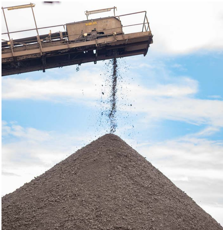
Chute de minerai en sortie de crible.
